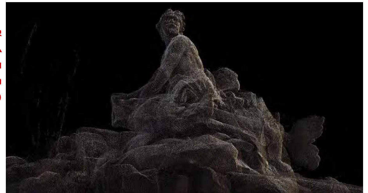
2017, RILIEVO LASER SCANNER DELLA FONTANA DEI COLLINO E SUOI GRUPPI SCULTOREI, CASTELLO DUCALE DI AGLIE' (TO)
